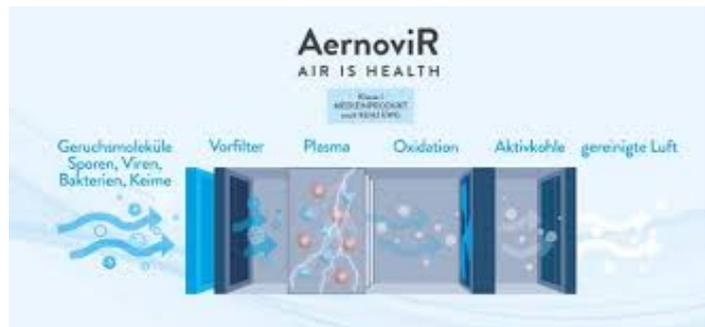
Das Gerät reinigt die Raumlufth effektiv und kontinuierlich von Viren, Keimen, Bakterien und Allergenen mit professioneller Plasma-Technologie. Diese sorgt dank ihres hohen Reinigungsvolumens für eine dauerhaft gleichbleibende Entkeimung. Der große Vorteil der Plasmatechnologie liegt in der effektiven Zerstörung von gängigen Influenza- und Coronaviren sowie Keimen und Bakterien.
