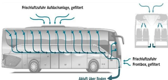
Nach der Erstreinigung durch ein HEPA-Filterssystem und dem Durchlaufen des Plasmafeldes vollendet der Aktivkohlefilter den Dreiklang der Reinigungsstufen und bindet übrig gebliebene chemische Verbindungen.
